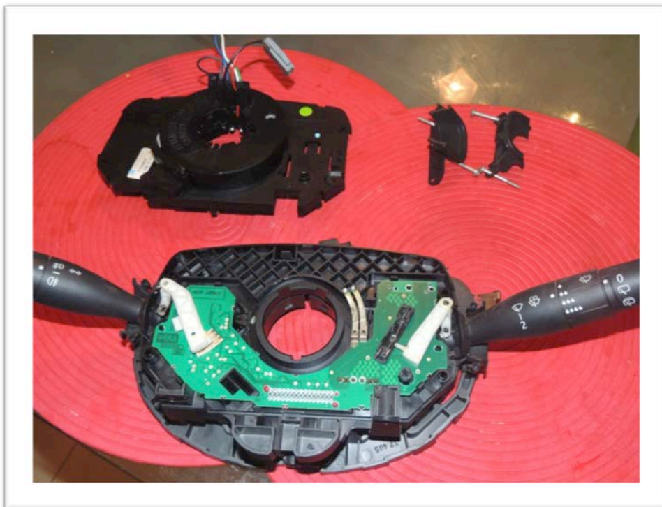
5. Gotowe – zwijacz zdemontowany.
